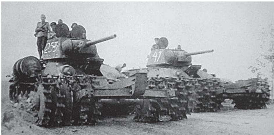
Танки Т-34, оборудованные противоминными тралами ПТ-3. 1943 г.
