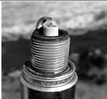
Рис. 6 - Износ свечи зажигания
