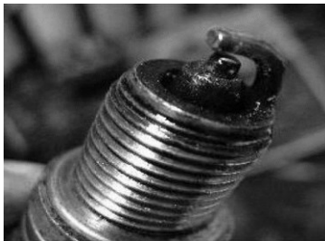
Рис. 3 - Чёрный, влажный налёт на электроде свечи
