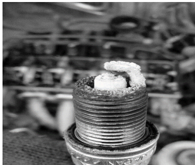
Рис. 5 - Свеча зажигания, покрытая белым налётом
