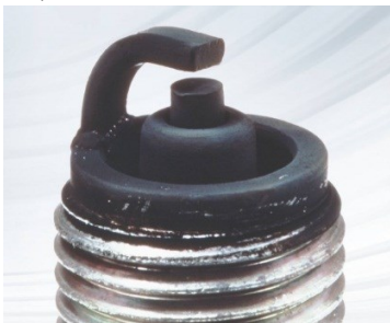
Рис. 2 -Неправильно работающая свеча из-за октанового числа топлива
