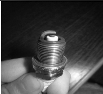
Рис. 1 - Правильно работающая свеча зажигания
