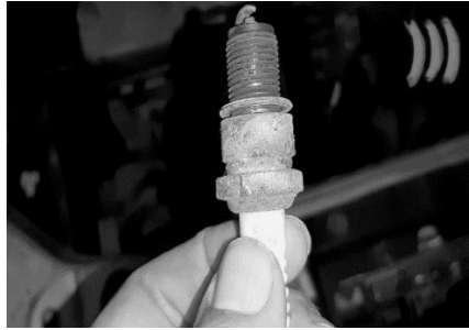
Рис. 4 - Коррозия корпуса свечи зажигания
