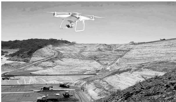
Рис. - Съёмка карьера с воздуха с помощью квадрокоптера DJI Phantom 4 RTK
