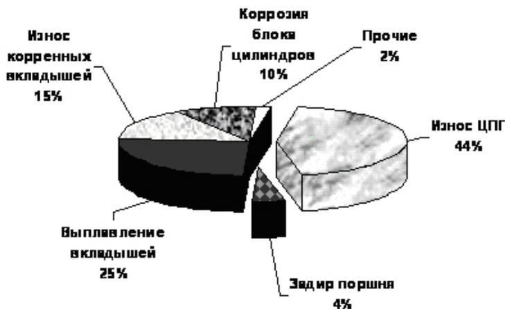
Рис. 1. Ресурсные отказы деталей и узлов автомобильных двигателей
