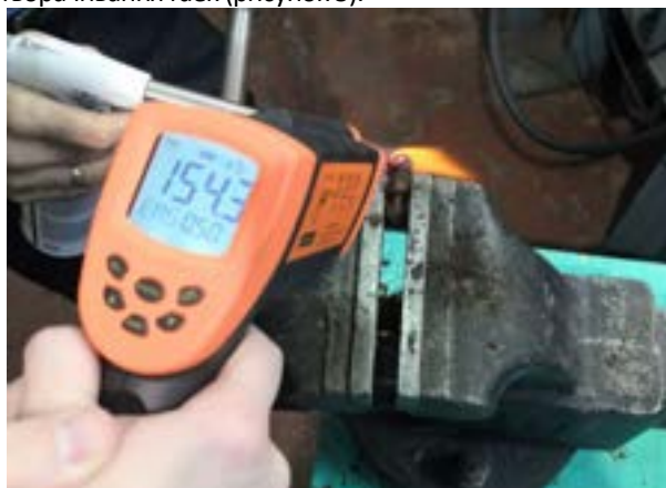
Рисунок 5 – Нагрев образцов газовой горелкой
