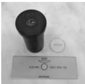
Рисунок 1 – Внешний вид окуляр-микрометра и объект-микрометра
