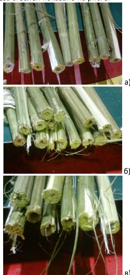
Рис. 3. Качество среза стеблей зубьями различных профилей: а) в форме параболы; б) в форме окружности; в) в форме трапеции
