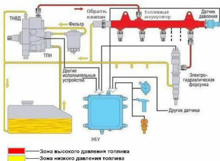
Рис. 1 – Принципиальная схема системы впрыска Common Rail
