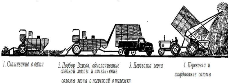
Рис. 1 – Поточный способ послеуборочной обработки зерна.
