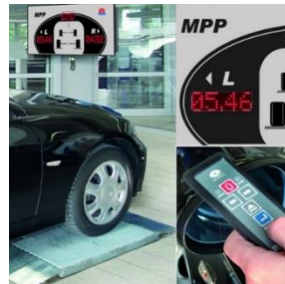
Рис. 3 – Площадочный тормозной стенд MPP 2140
