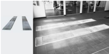
Рис. 2 – Платформенный тормозной стенд AutopStenhoj Testmaster PT440
