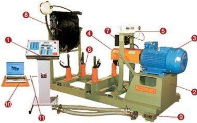
Рис. 1 – Электрический тормозной стенд:
