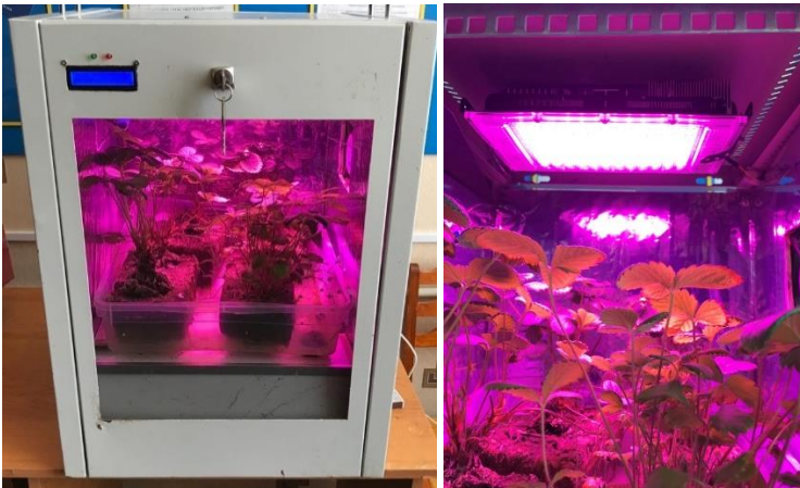
Рис. 1 – Разработанная гидропонная установка
