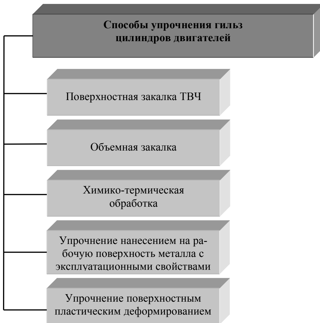
Рисунок 2 – Способы упрочнения гильз цилиндров
