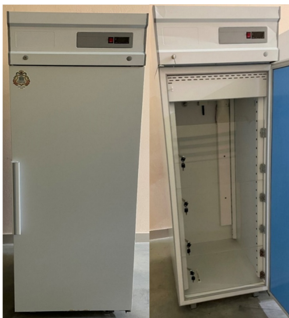
Рис. 1 – Общий вид макетного образца микроклиматической камеры для хранения мини-клубней картофеля
