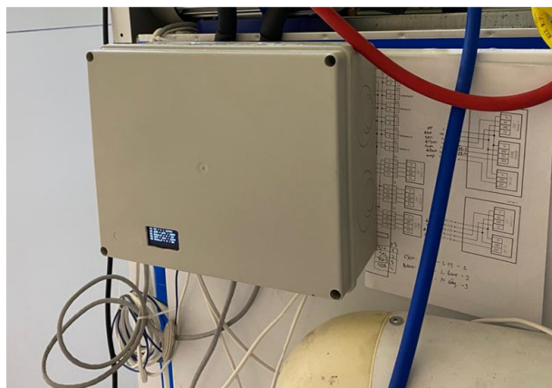
Рис. 2 – Общий вид блока системы управления и контроля макетного образца микроклиматической камеры для хранения мини-клубней картофеля
