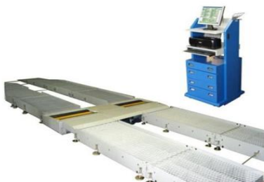
Рис. 1 – Мобильный универсальный стенд СТС-13У-СП-14
