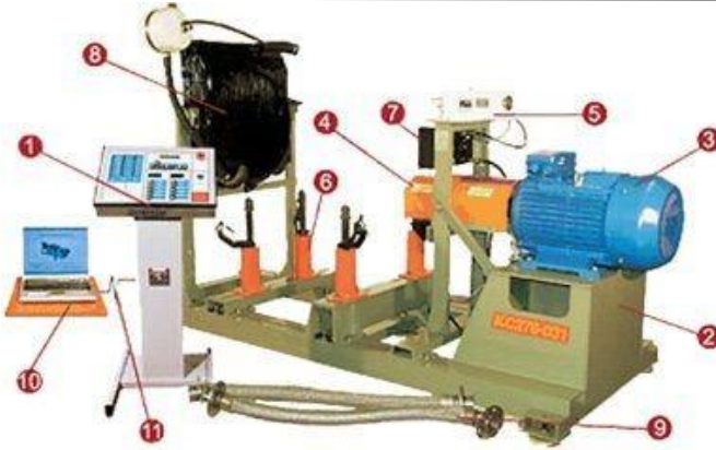
Рис. 1 – Электрический тормозной стенд:
