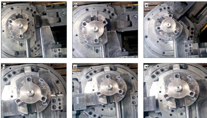
Рис. 1 – Этапы процесса дуговой гибки труб:
