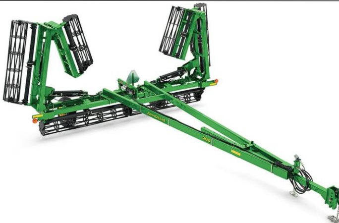
Рис. 1 – Прутковый прикатывающий каток 200
