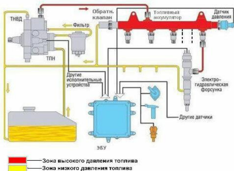
Рис. 1 – Принципиальная схема системы впрыска Common Rail
