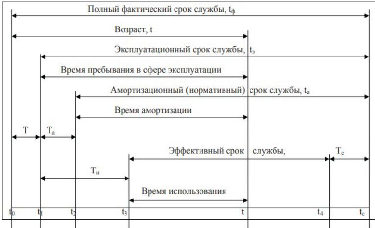
$t_0$  - производства машин;  $t_1$  - поставка машины в эксплуатирующее предприятие;  $t_2$  - поставка машины на баланс предприятия;  $t_3$  - начало использования машины по назначению;  $t_4$  - прекращение использования машины по назначению;  $t_c$  - списание машины с баланса предприятия;  $T_a$  - время задержки амортизации;  $T_n$  - время задержки начала использования;  $T_c$  - время задержки списания.
