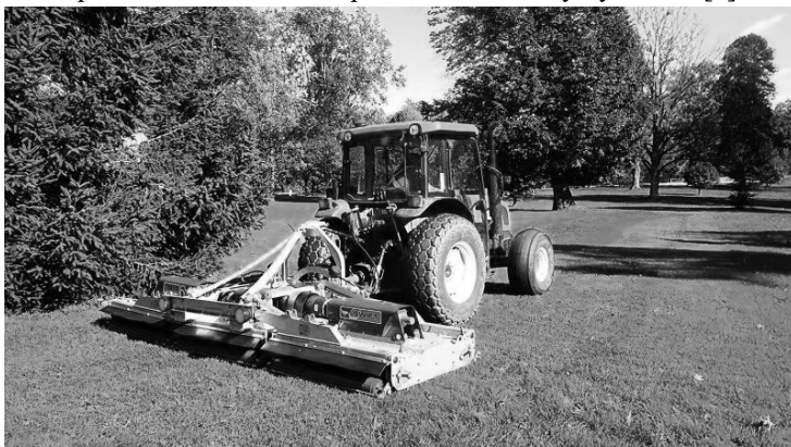
Рис. 1 - Складная роторная косилка большой площади с трехточечной навеской (Major)
