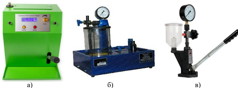
Рис. 1 - Стенды для проверки дизельных форсунок: а) стенд-насос СН – 400; б) стенд ДД-2110; в) стенд для проверки дизельных форсунок ROCK FORCE
