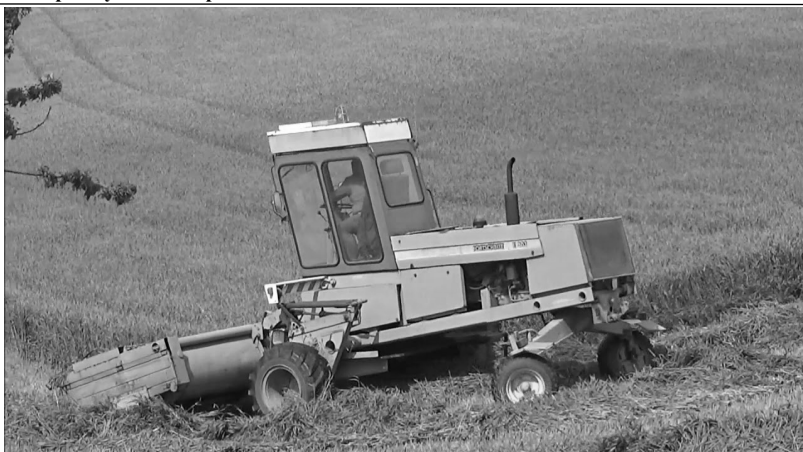
Рис. 3 – Fortschritt E303 — самоходная косилка-плющилка из ГДР
