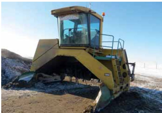
Рисунок 13. Ворошение помета на полигоне с применением ворошителя в условиях осенних заморозков.
