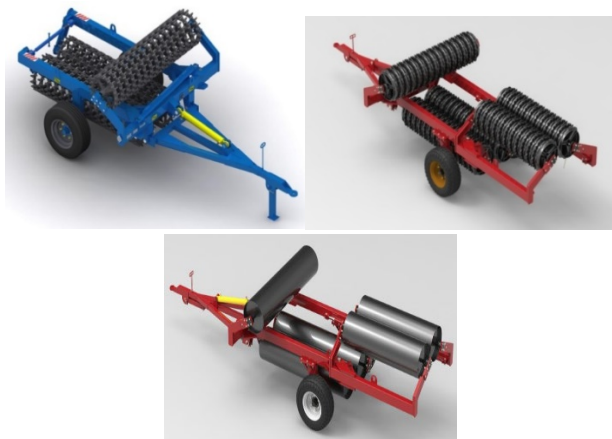
Рисунок 1 – Кольчато-шпоровый (а), кольчато-зубчатый (б) и гладкий цилиндрический (в) каток
