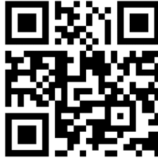
Рисунок 3 - Пример полос синхронизации на QR коде версии 2
