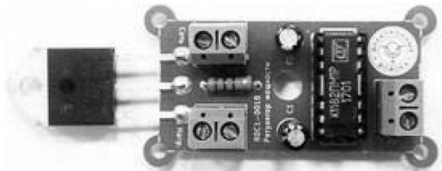
Рисунок 2 – Общий вид фазового регулятора мощности RDE(C)-0018 на симисторе ВТА41-600 и микросхеме К1182ПМ1Р (220В).
