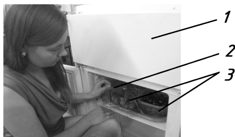
1 – холодильный шкаф; 2 – датчик температуры; 3 – пищевые продукты
