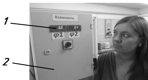
1 –табло влажности воздуха камеры; 2 – контроллер DIXELL Рисунок 5 – Определение влажности воздуха в холодильной камере
