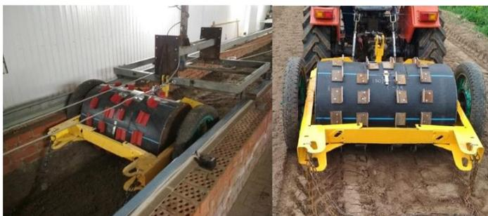
**Рисунок 2 – Экспериментальная сеялка в почвенном канале и полевых условиях на базе Казанского ГАУ**
