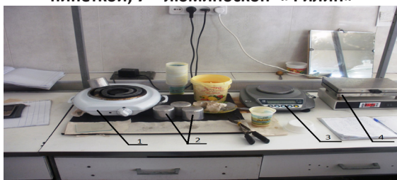
Рисунок 3 – Оборудование лаборатории №2: 1 – плитка электрическая; 2 – стаканчики для растапливания масла; 3 – весы электронные; 4 – аппарат сушильный
