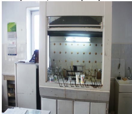
Рисунок 4 – Оборудование лаборатории №3: 1 – прибор для отмеривания серной кислоты; 2 – прибор для отмеривания изоаминового спирта; 3 – штатив с жиромерами (бутирометр); 4 – пипетки для определения жирности; 5 – стакан со сливками; 6 – стакан с маслом
