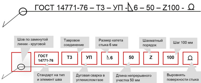
Рисунок 2 - Пример обозначения сварочного шва и его расшифровка
