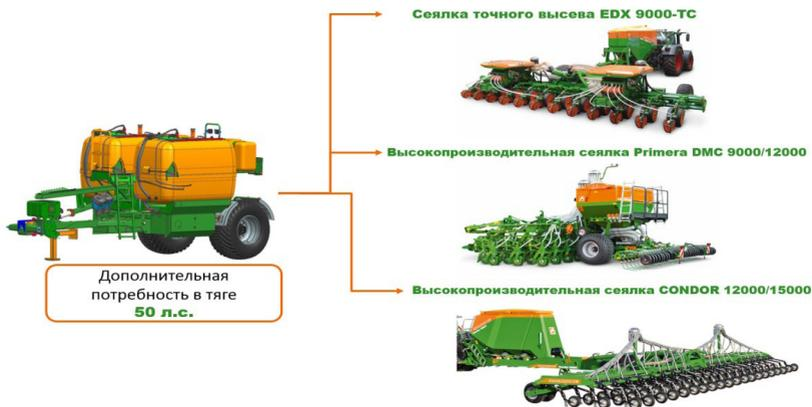
Рисунок 6 - Агрегат FDC-6000 для внесения жидких минеральных удобрений одновременно с посевом
