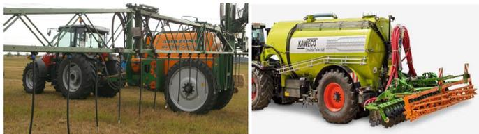
Рисунок 5 - Агрегаты для поверхностного(опрыскивателями) и под дискование(Catros) внесения жидких удобрений КАС и ЖКУ
