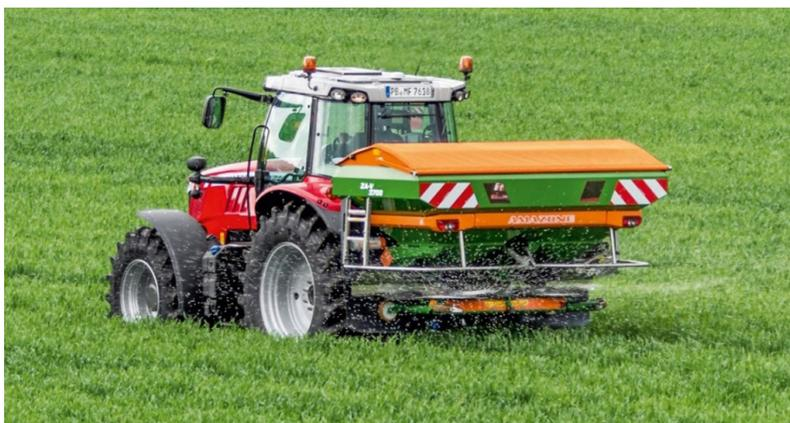
**Рисунок 8 - Навесной разбрасыватель минеральных удобрений
