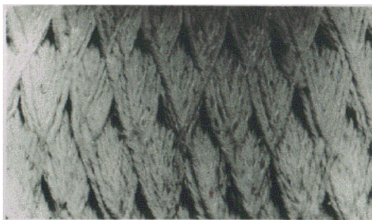
Рисунок 2 - Внешний вид аэратора спиралевидного строения намотки
