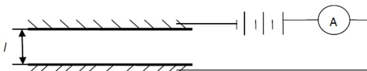
**Рисунок 2 - Измерение контактной разности потенциалов**
