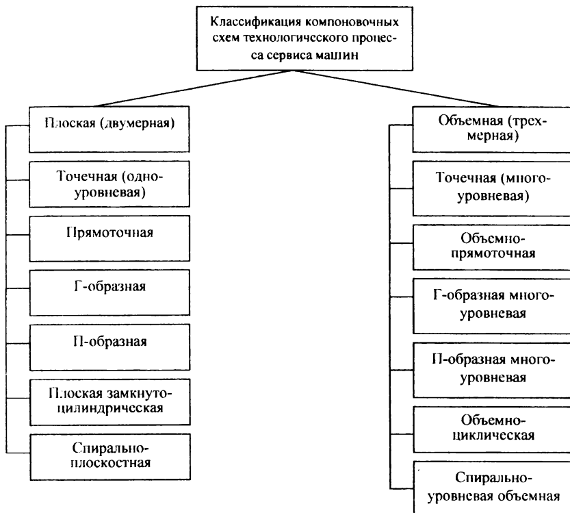
Рис.1 Варианты схем технологического процесса технического сервиса машин
