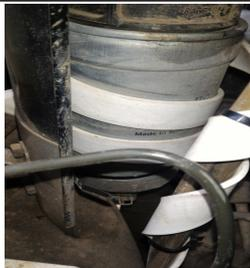
**Рисунок 2 - Ленточный подогреватель**
