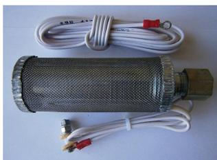
**Рисунок 3 - Подогреватель топливозаборника**
