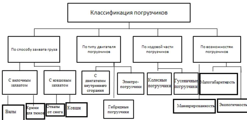
**Рисунок 3 - Классификация фронтальных погрузчиков**
