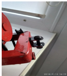
Рисунок 3 - Фаркоп на навесной сегментной косилке
