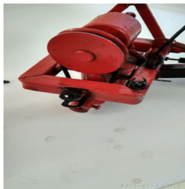
Рисунок 3 - Фаркоп на навесной сегментной косилке
