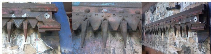
Рисунок 5 – Крепление пальца к брусу
