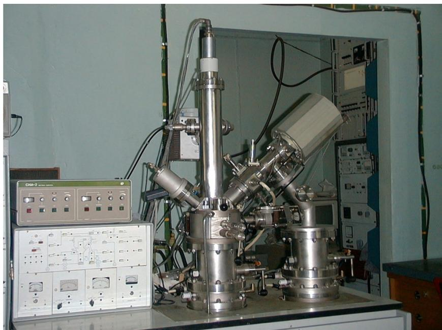
Рисунок 3.17 – Вторично-ионный масс спектрометр MS7202M
