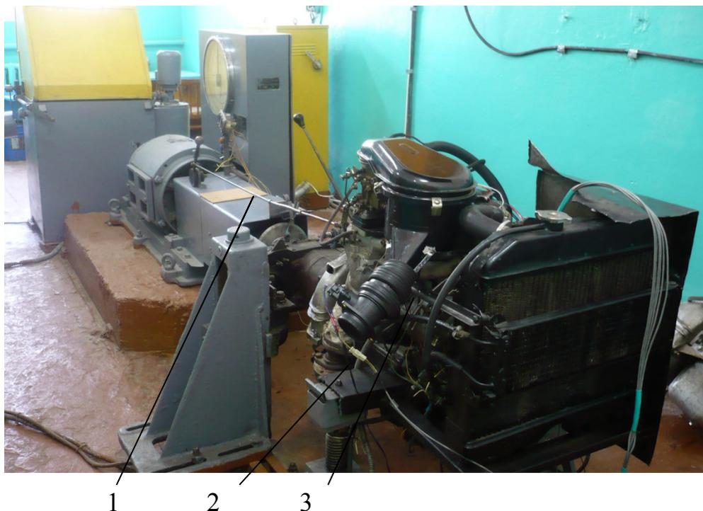
1 – стенд тормозной КИ-5543; 2 - система отвода отработавших газов; 3 – двигатель УМЗ-417
