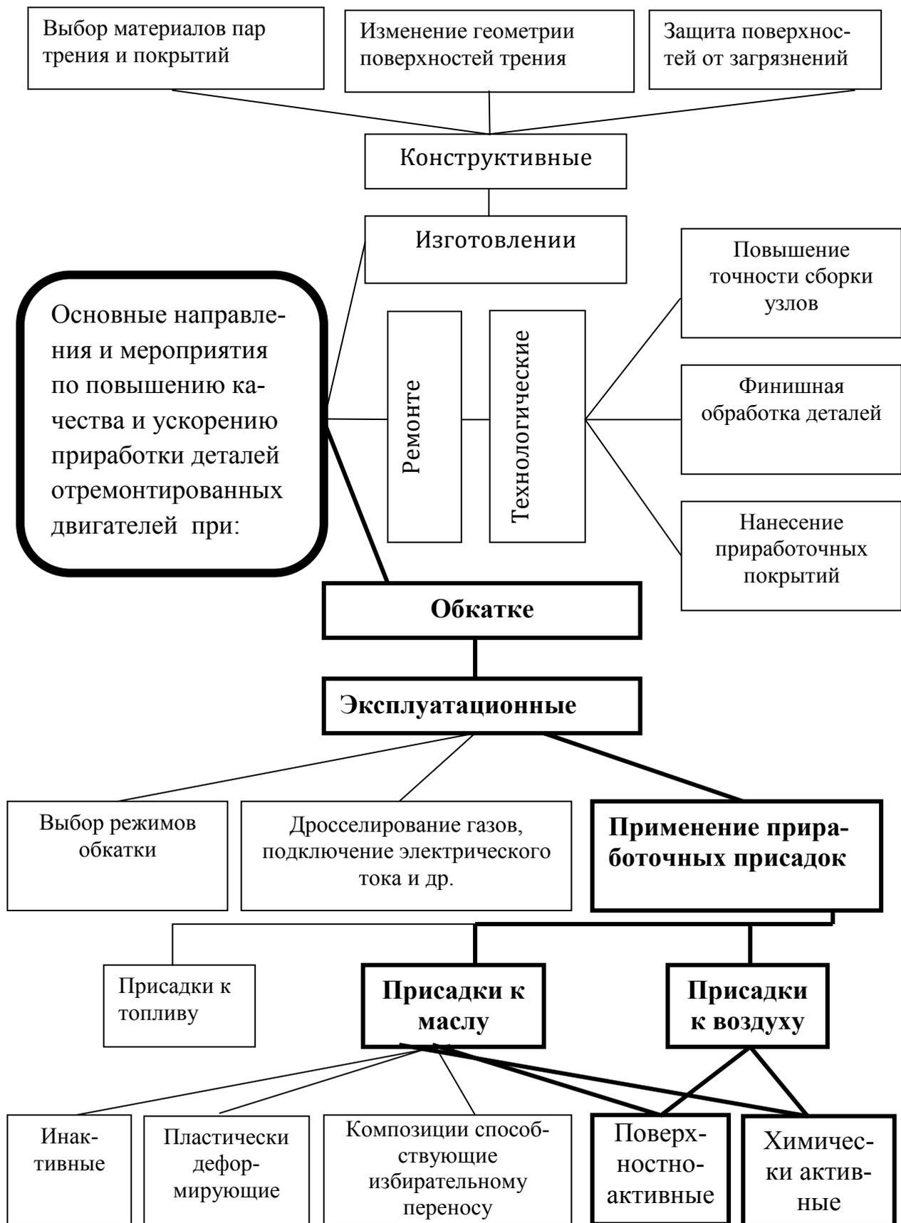
Рисунок 1.4 - Классификация мероприятий по ускорению приработки деталей двигателя
