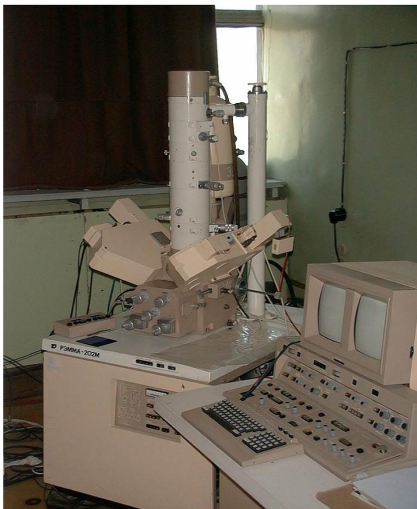
Рисунок 3.16 – Растровый электронный микроскоп РЭМ-101
