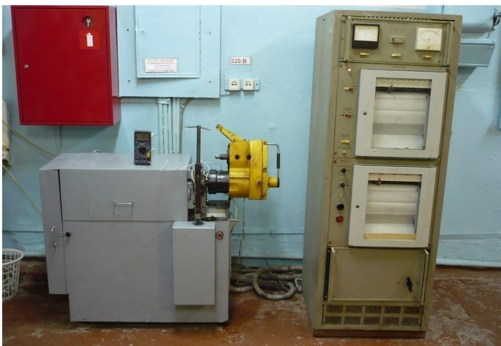
Рисунок 3.2 - Общий вид машины трения 2070 СМТ-1
