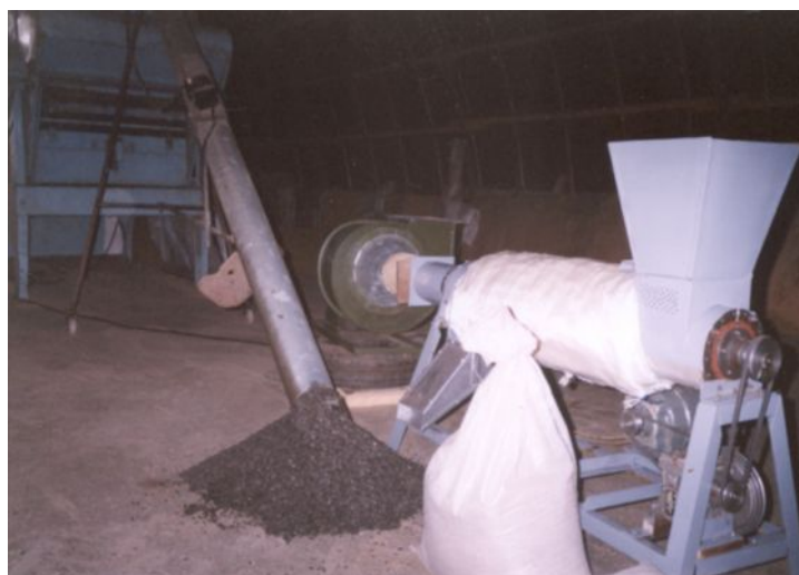
Рисунок 4.34 - Технологическая линия подработки семян подсолнечника
