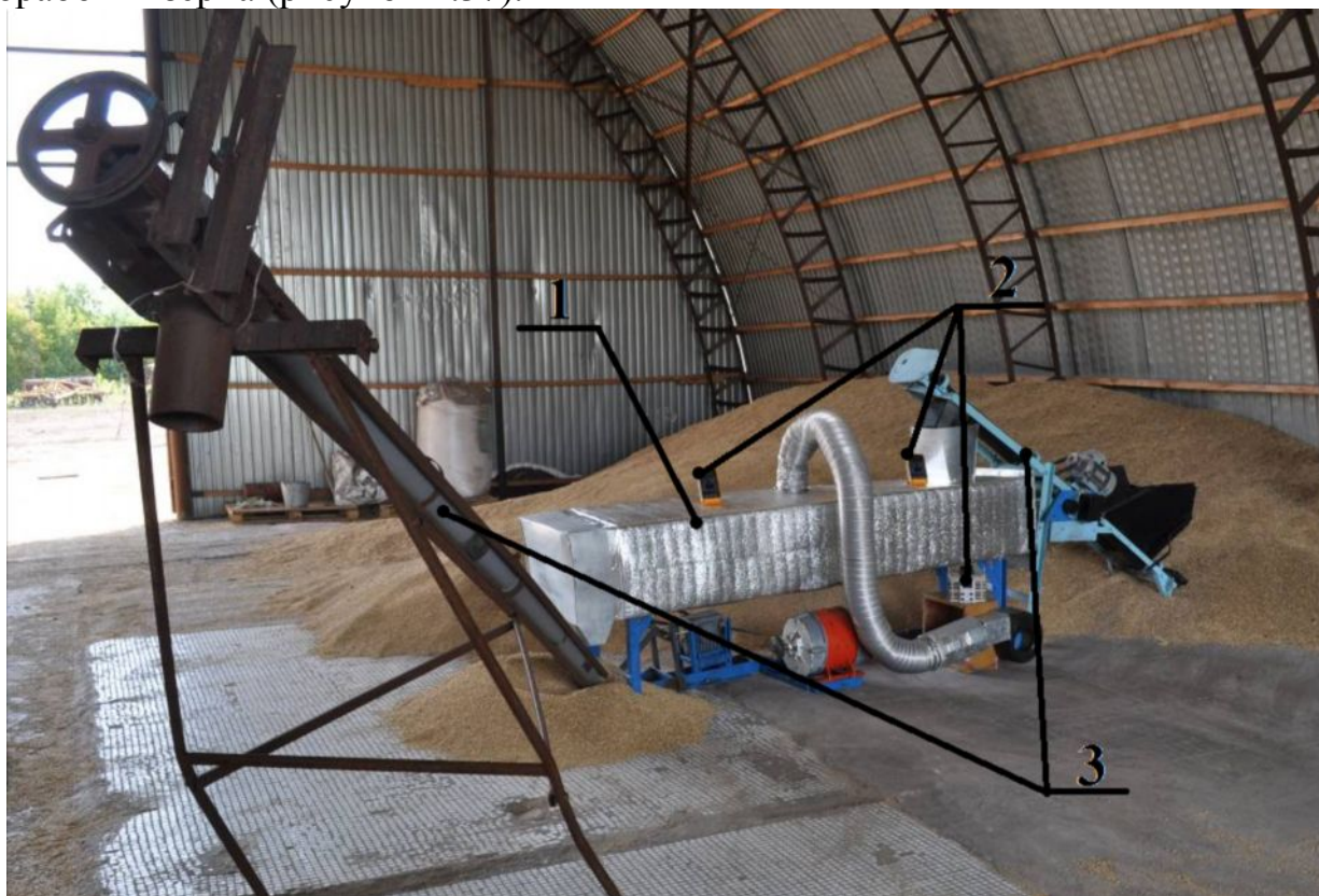
Рисунок 4.37 - Фрагмент технологической линии подработки зерна: 1 – УТОЗ 4; 2 - контрольно-измерительная аппаратура; 3 - погрузчик зерна со спирально-винтовым рабочим органом
