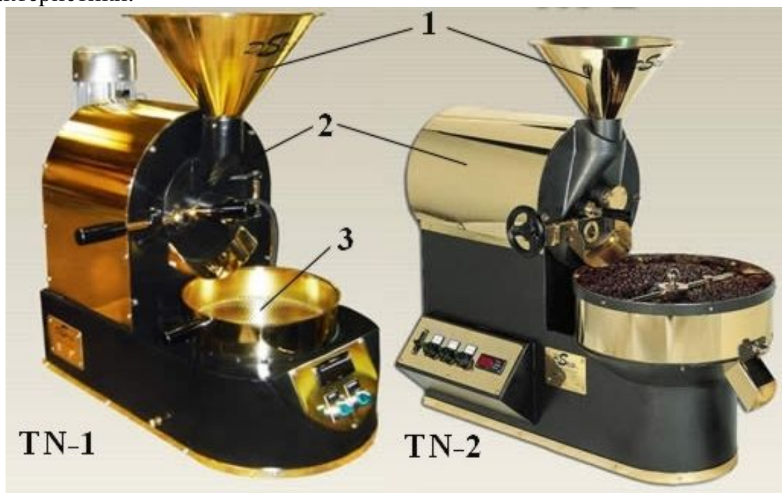
Рисунок 1.5 – Кофе-ростеры периодического действия (обозначения в тексте)
