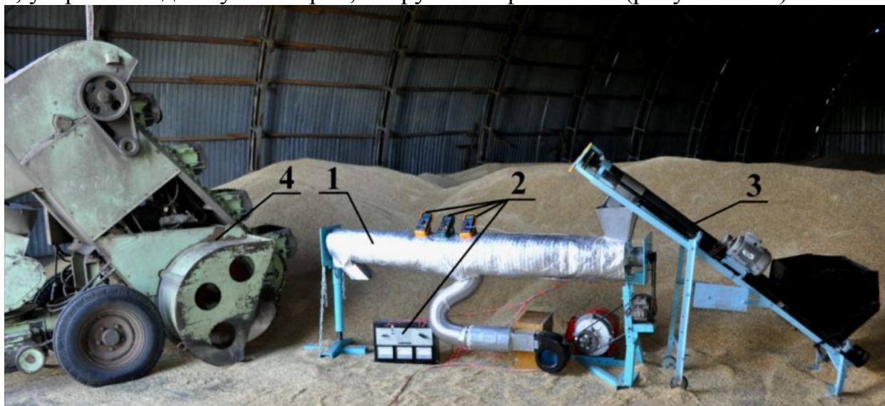
Рисунок 4.36 – Фрагмент технологической линии подработки зерна: 1 – УТОЗ 3; 2 – контрольно-измерительная аппаратура; 3 – погрузчик зерна со спирально-винтовым рабочим органом; 4 – погрузчик зерна КШП
