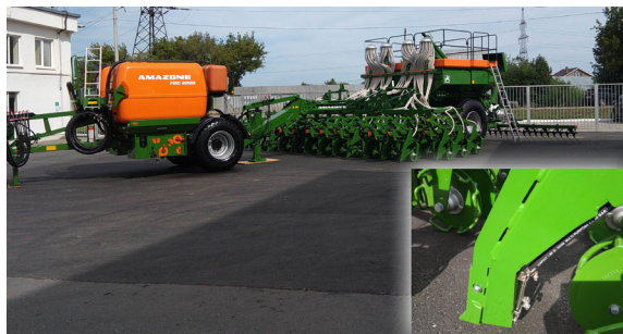
Рисунок 1 - Универсальный агрегат FDC 6000 с сеялкой Primera DMC 9000, оборудованной системой подачи жидких удобрений под анкерный сошник
