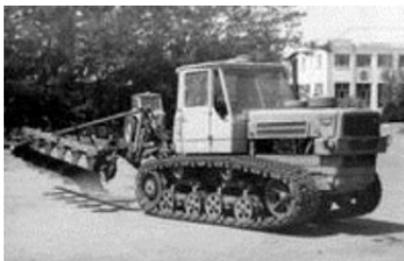
**Рисунок 5 – Трактор с пневматической гусеницей**
