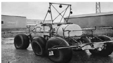
**Рисунок 2 - Вездеход на шинах сверхнизкого давления**
