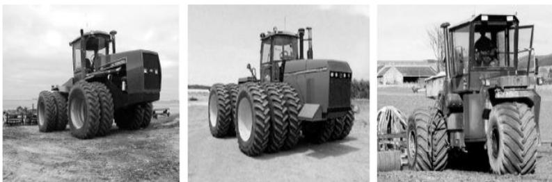
**Рисунок 1 – Трактора со спаренными и арочными шинами**
