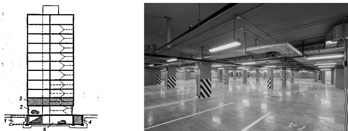
Рисунок 3 - Автостоянка под жилым домом, не имеющим квартир в нижних этажах: 1 – возможное развитие автостоянки; 2 – открытая автостоянка; 3 – технический этаж; 4 – коридор; 5 – закрытая отапливаемая автостоянка
