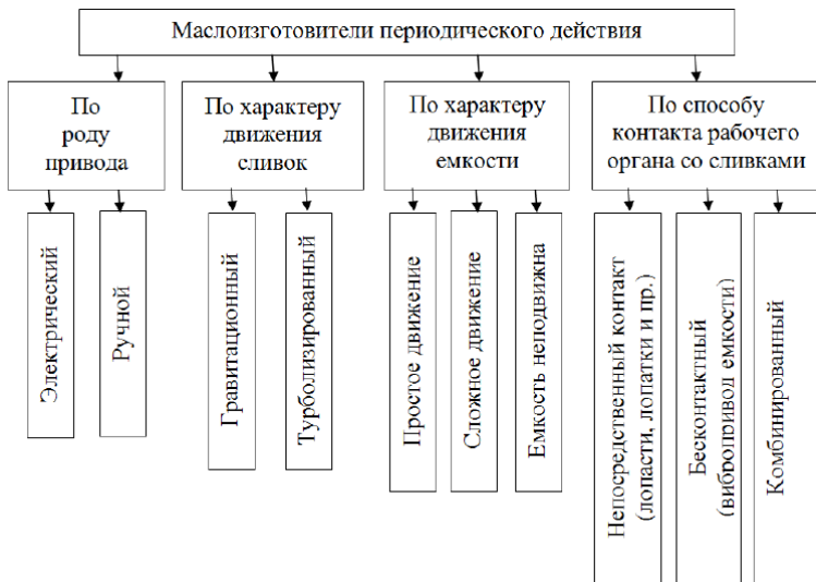
Рисунок 1 – Классификация маслоизготовителей периодического действия
