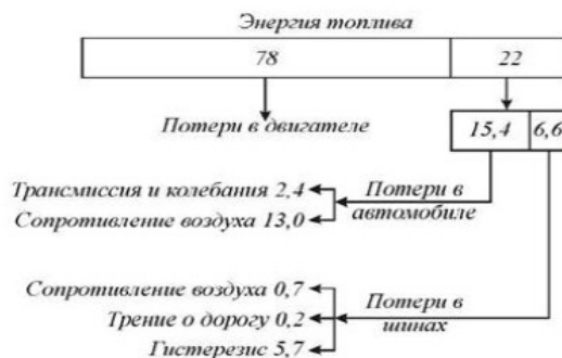
Рисунок 1 – Примерный топливный баланс легкового автомобиля при движении со скоростью 80 км/ч по горизонтальной дороге при температуре -18°C
