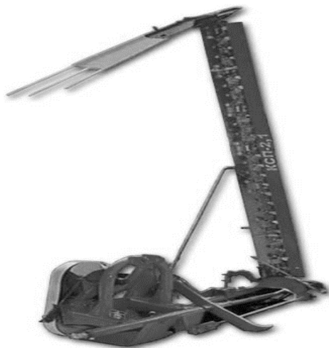
Рисунок 2 - Подъем режущего аппарата косилки с защитным кожухом
