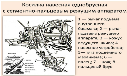
Рисунок 1 - Косилка навесная однобрусная с сегментно-пальцевым режущим аппаратом
