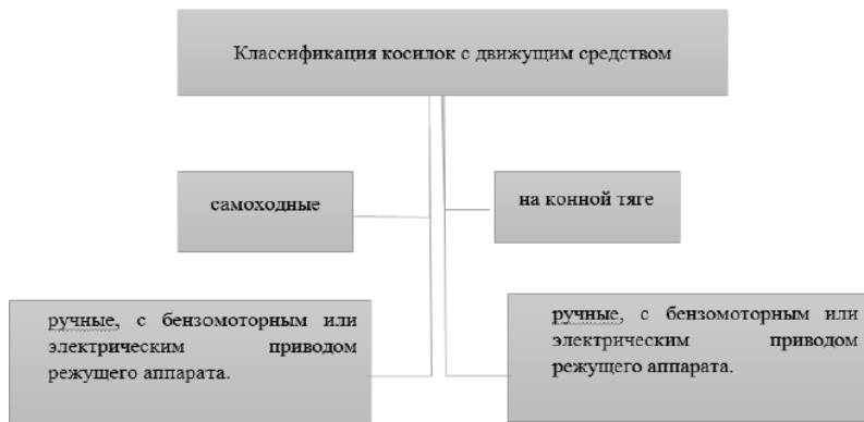
Рисунок – 1 Классификация косилок с движущим средством
