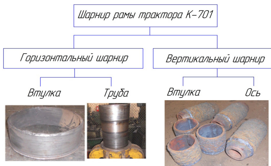
Рис. 3 – Состав шарнира рамы трактора К-701
