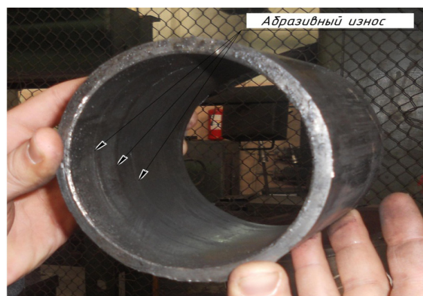
Рис. 4 – Следы износа рабочей поверхности втулки вертикального шарнира
