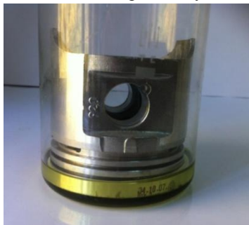
Рисунок 3.5 – Обработка оксидированного поршня раствором 32
