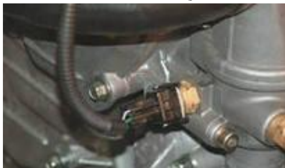
Рисунок 3.16 – Подключение датчика температуры мультиметра MGT-300 в корпус термостата двигателя УМЗ-417
