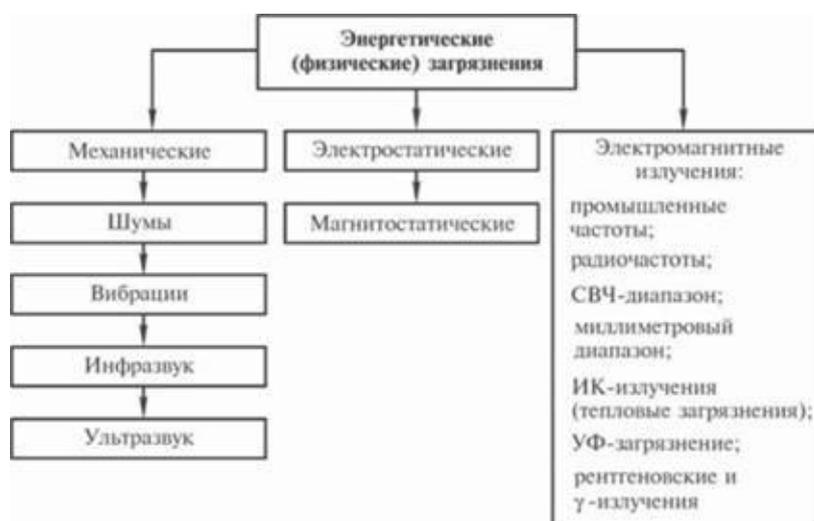
Рис. 1 - Классификация энергетических загрязнений
