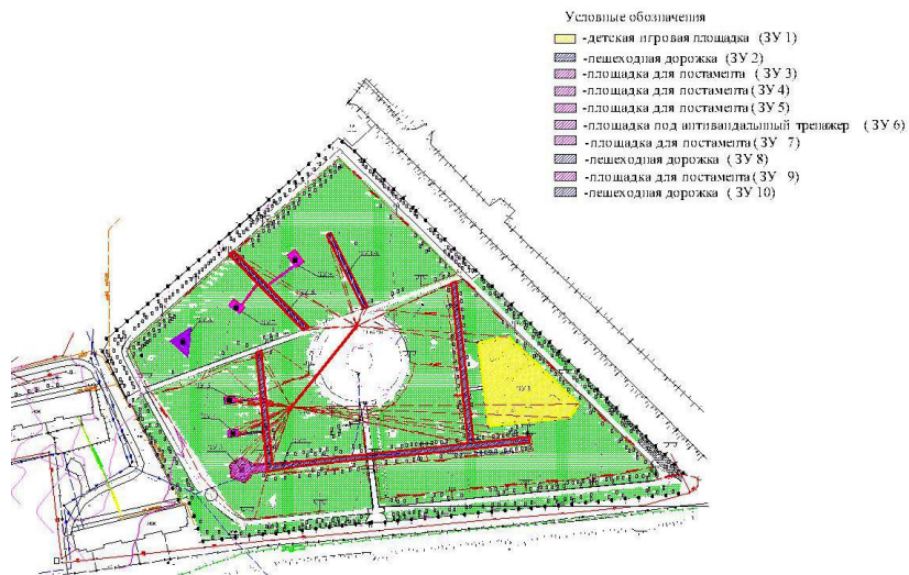
Рисунок 1 – Схема разбивки, вынос объектов планировочных решений на местность
