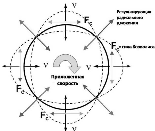
Рисунок - 1 Режимы работы сенсорного кольца при вращающемся гироскопе
