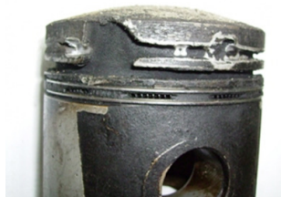
Рисунок 1 – Износ деталей ЦПГ: а) износ внутренней рабочей поверхности гильзы цилиндра; б) разрушение поршневой канавки
