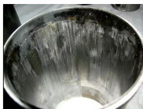
Рисунок 1 – Износ деталей ЦПГ: а) износ внутренней рабочей поверхности гильзы цилиндра; б) разрушение поршневой канавки
