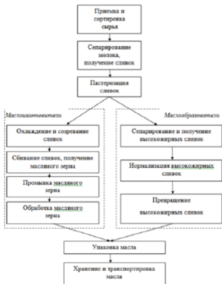
Рисунок 1 – Технологические схемы получения сливочного масла
