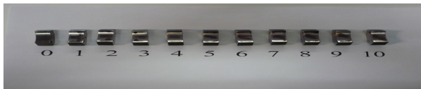
Рисунок 1 – Образцы со вставками цветного металла
